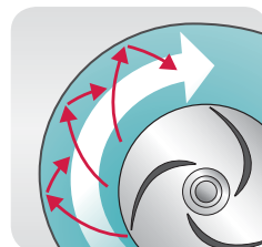
Стандартное рабочее колесо не предполагает однородность потока.
